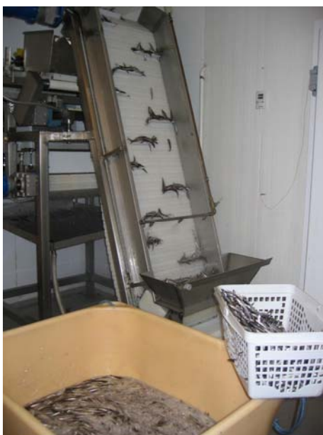
Kuva 10. Padasjoen irtopakastuslaitteen alkupää: pientä muikkua nousee syöttökaukalosta pakastuslinjastoon (Kuva: Hanna Peltomäki).
